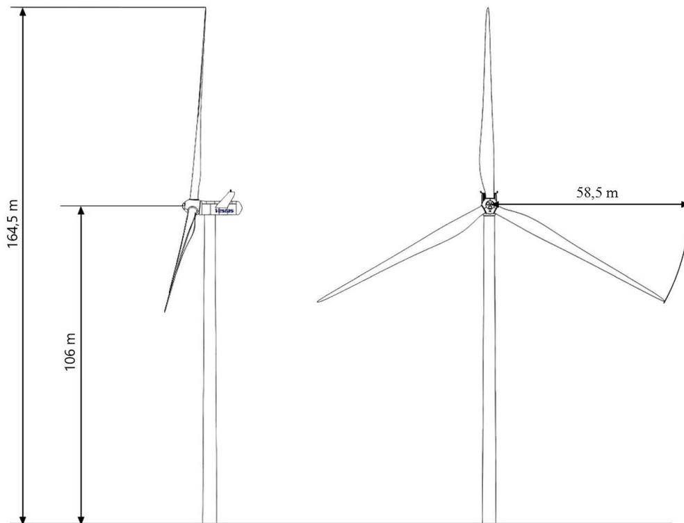
Figure 5 : Dessin d'élévation de l'éolienne Nordex N117 – 3,6MW
