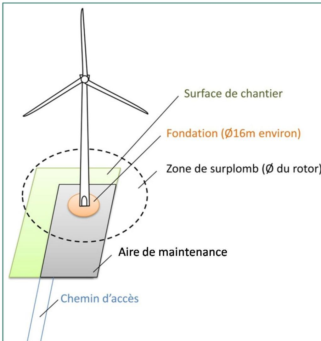
Figure 7 : Aires de montage et d'entretien des éoliennes
